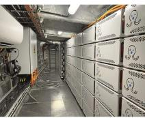
Die Frisia E-1 wird mit insgesamt 180 Batterien angetrieben.
