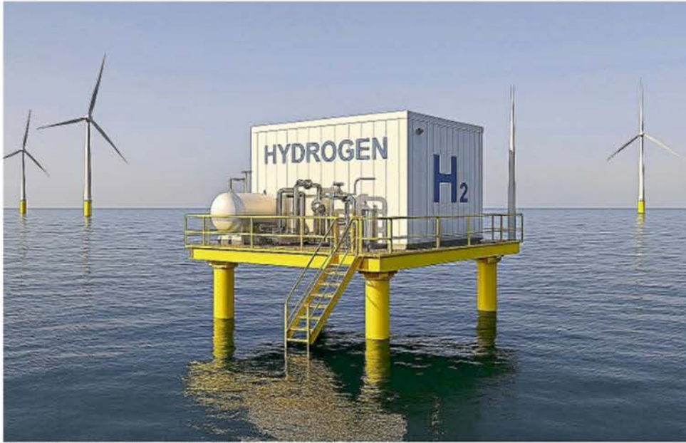
Mit Windkraft wird der Wasserstoff durch Elektrolyse direkt auf See erzeugt.
