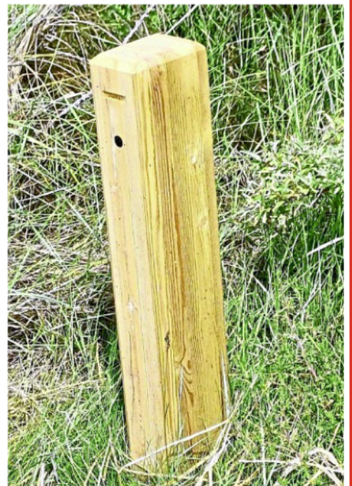
In den kleinen Holzpfeuern steckt Infrarottechnologie, mit deren Hilfe Besucherströme gelenkt werden. Foto: Stefan Erdmann
