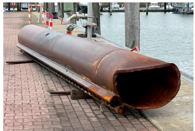
Der von Tauchern durchgetrennte Haltepfahl der Verlegebarge liegt derzeit im Hafen.
