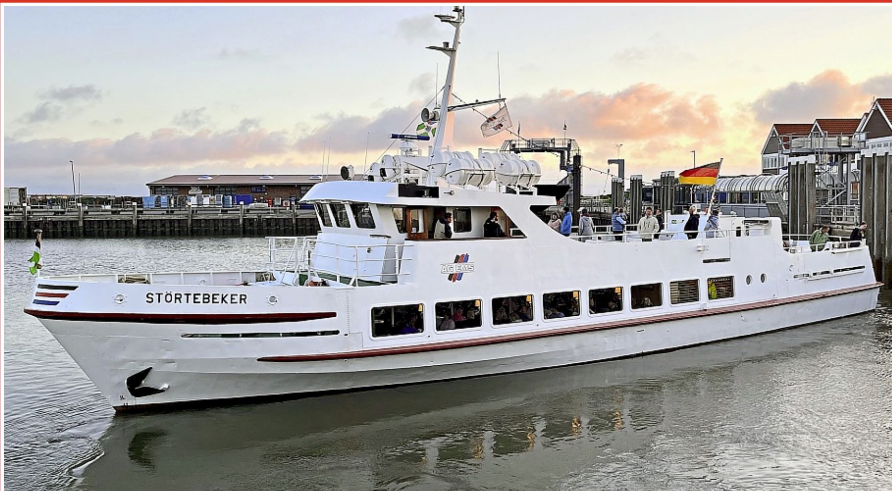
Die „Störtebeker“ wurde 1969 gebaut, ist knappe 30 Meter lang und mit neuen Motoren ausgestattet.
