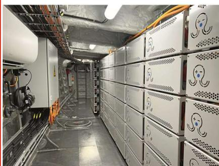
Die Frisia E-1 wird mit insgesamt 180 Batterien angetrieben.
